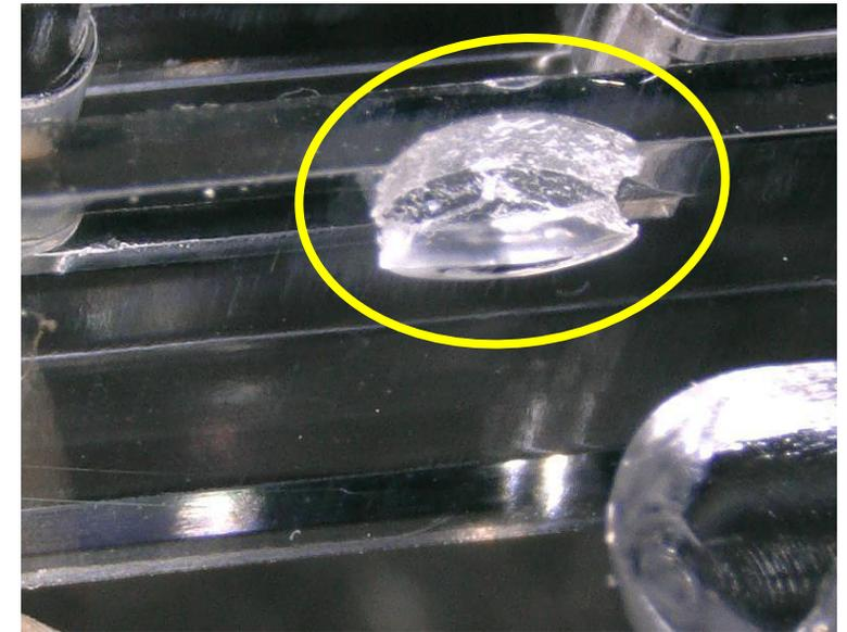
※ピン配置が悪いため、成形品を突き破って欠けた状態となっている
